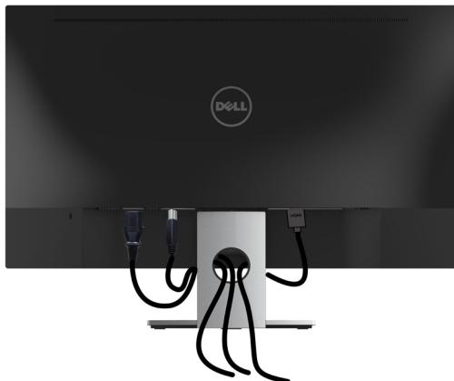
หลังจากที่ต่อสายเคเบิลที่จำเป็นทั้งหมดไปยังจอภาพและคอมพิวเตอร์แล้ว (ดู [การเชื่อมต่อจอภาพสำหรับการต่อสายเคเบิล](#)) จัดระเบียบสายเคเบิลทั้งหมด ดังแสดงด้านบน
